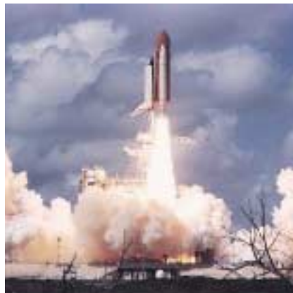
İlki 1981 yılında tamamlanan ve göreve başlayan uzay mekikleri, yeniden kullanılabilen, insanlı uzay araçlarıdır. Ne var ki tek aşamalı değildir. Kendi roket motorlarına ek olarak büyük bir sıvı yakıt tankı ve onun iki yanında yer alan ek katı yakıt roketleri bulunur. Tıpkı bir roket gibi kalkar ve uçar gibi inerler.
