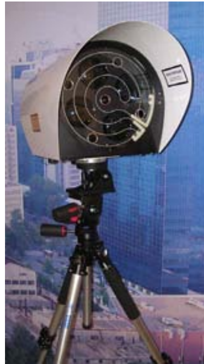
Teleskopa benzeyen bu alet, lazer ışınları yardımıyla yüksek hızlı veri iletişimi kurabilen bir Free Space Optics cihazı.
