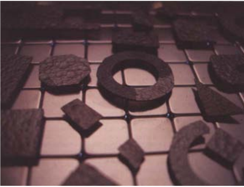
Çeşitli şekillerde kesilmiş pirolitik grafit parçalar ilginç bir şekilde havada duruyor. Bu resimdeki düzenekte, kalıcı bir mıknatısın üzerinde asılı 120 cisim var. Aktif geribildirimli kullanarak aynı cisimleri havaya kaldıracak ve dışardan verilen güçle çalışacak bir aygıt, tasarım ve üretim açısından önemli bir mühendislik girişimi olurdu. Buradaki basit, pasif diamanyetik yükselme sistemi ise bu işi daha kolay yapar.
