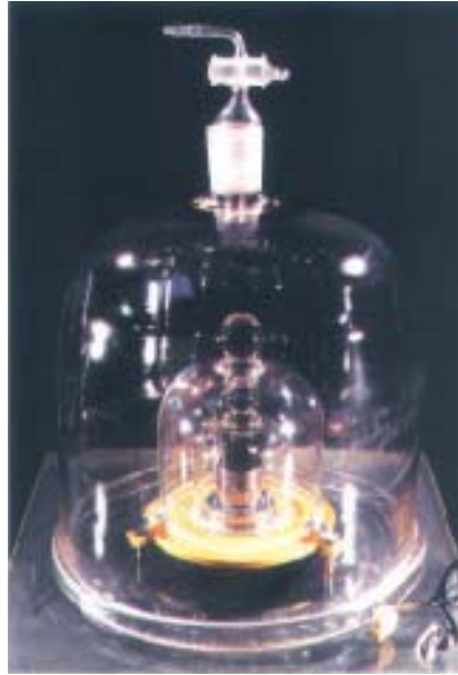
Bir nesnenin kütlesini doğru olarak bilmenin tek yolu, Fransa'daki Sèvres'e gidip, onu kilogramın uluslararası prototipiyle kıyaslamak. Resimde prototipin bir kopyası görülüyor. Kilogram, fiziksel bir nesneyi temel alan SI birim sistemindeki son birim; ancak metrologlar, kütle için daha temel bir tanımlama arayışındalar.
