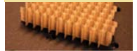
Şekil 3: UCSD’deki grubun negatif kırılmayı gözlemlediği metamatizme. Burada kesik halkalı rezonatörler ve onların arkasına yerleştirilmiş bakır teller, malzemenin mikrodalgalarla karşı negatif kırılma indisi göstermesini sağlıyor. Burada rezonatörler ve teller fiberglas bir devre kartı üzerine basılmış.
