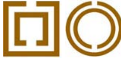
Şekil 2: İki farklı geometrideki kesik halkalı rezonatörler
