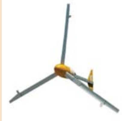
Şekil 3: Bu modelin, 7,5 ve 10 kW'lık iki tipi var. 10 km/saat'lik rüzgar hızlarında çalışmaya başlıyor ve tasarımı, 180 km/saat'e kadarki hızlara dayanabiliyor. Çok değişik rüzgar koşullarında üretim yapabildiği ve sahip olduğu yüksek güç düzeyi, konut uygulamaları için uygun. Türbin çıkışında üretilen gerilim 120 VAC. Şarj denetleyicisi ve AC-DC çeviriciye ek olarak bir de, 4'e 1 sarımlık trafoya sahip. Dolayısıyla, 120 VAC'lik türbin çıkışını, hem dönüştürüp hem de düşürerek, 24VDC'lik bir akü grubunu besleyebiliyor.
