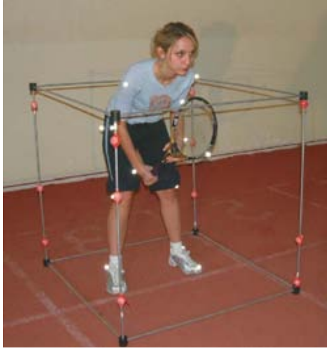
Bu sporcunun üzerindeki noktaların, uzaydaki konumlarını bilinmediğinden kalibrasyon (ayarlar) kafesi yardımıyla, kafesin üzerindeki bilinen noktalara, sporcunun üzerindeki bilinmeyen noktaların yerleri tahmin edilerek bulunabiliyor.
