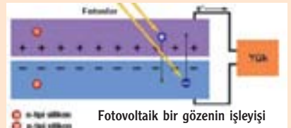
Fotovoltaik bir gözede elektrik alanının etkisi
