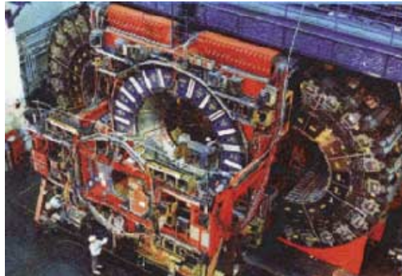
Hızlandırıcılarda parçacık çarpışmalarından ortaya çıkan ürünler, apartman büyüklüğünde duyarlı dedektörlerle izlenerek, türleri ve hızları belirleniyor.
