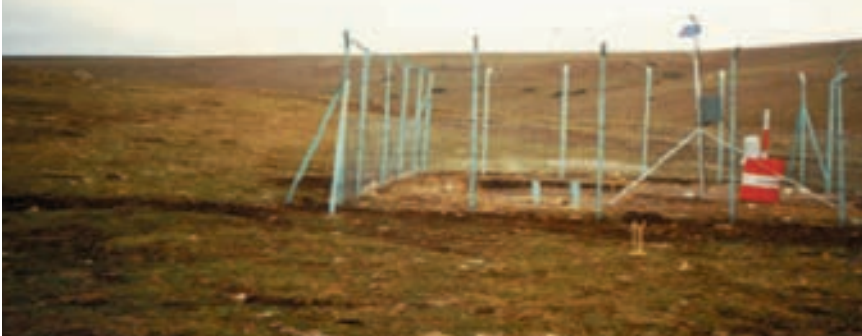
Doğu Anadolu'da (Ilıca) 2200 metre yükseklikte kurulu tam otomatik kar istasyonu. Toprak altında 4 adet 1 m 2 'lik çelik kar yastığı bulunmakta. Güneş enerjisi ile beslenen istasyonlardan veriler uydu aracılığıyla merkeze aktarılmakta.
