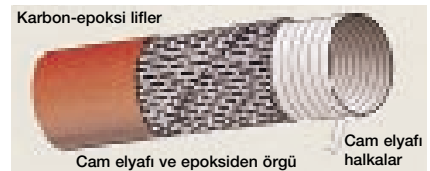
Karbon liflerinden yapılmış sığın kesiti
