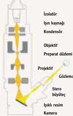
Bir elektron mikroskobunun yapısı
