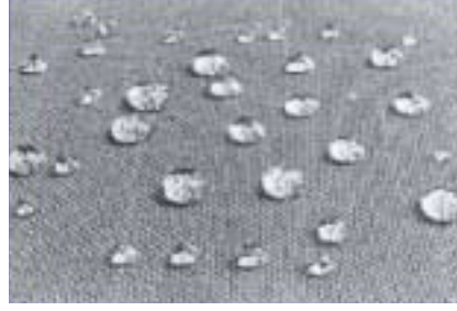
Çeşitli polifosfazen yapılar. a) Ayırma işlemlerinde kullanılan membran, b) Tekstil malzemesi olarak kullanılan aşırı hidrofobik (suyu sevmeyen) polifosfazen, ıslanmayan giysilerin üretiminde tercih edilir. c) Çok hidrofilik (suyu seven) polifosfazen jel yapısı, suyu absorplayarak şişer.
