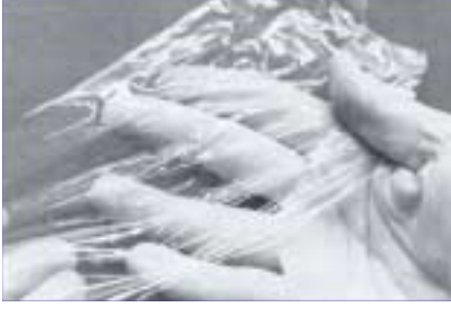
Çeşitli polifosfazen yapılar. a) Ayırma işlemlerinde kullanılan membran, b) Tekstil malzemesi olarak kullanılan aşırı hidrofobik (suyu sevmeyen) polifosfazen, ıslanmayan giysilerin üretiminde tercih edilir. c) Çok hidrofilik (suyu seven) polifosfazen jel yapısı, suyu absorplayarak şişer.
