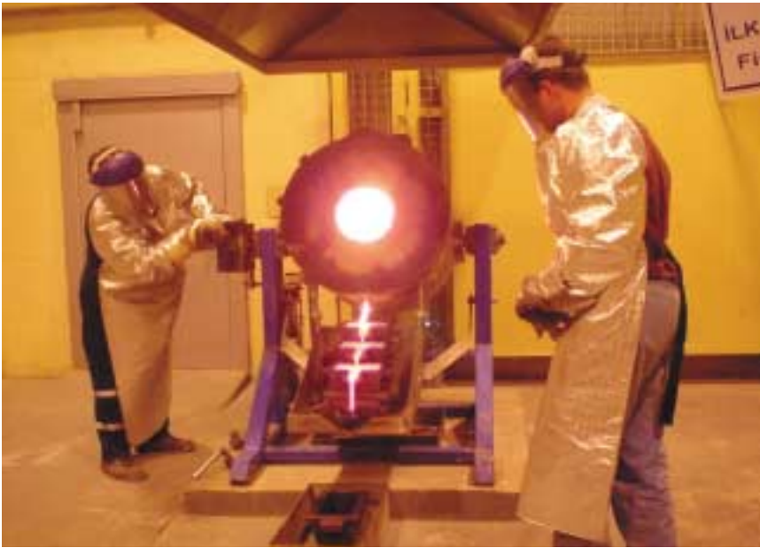
Karbon, çözeltiden sıyırıldıktan sonra, altın ve gümüş içeren çözelti, elektrolit hücrelerinden geçiriliyor. Elde edilen altın ve gümüş tanecikleri 1200°C'de eritilerek, son ürün olarak külçelere dökülüyor.
