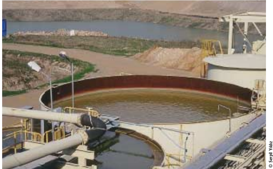
Tanklara alınan, öğütülmüş çamur halindeki cevhere burada siyanür ilavesi yapılıyor. Çözeltinin altın ya da gümüş içermeyen kısmı arıtma ünitesine gönderiliyor. Cevher içeren kısım, karbon adsorpsiyonu ve diğer işlemler için öteki tanklara aktarılıyor.
